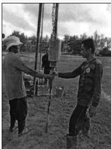
รูปที่ 3-4 การสำรวจลักษณะชั้นดินภายในพื้นที่โครงการ
